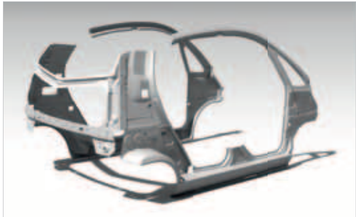
Abb. 6: 3D-Geometrie nach dem Reverse Engineering [2]
