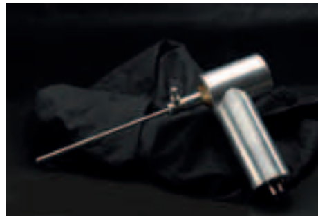
Abbildung 4: Das im Laboratorium für optische Messtechnik entwickelte Interferoskop
