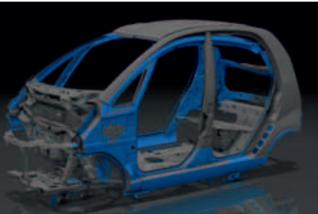
Abb. 5: Überlagerung von zwei Punktwolken der Karosserie vor und nach dem Umbau [2]
