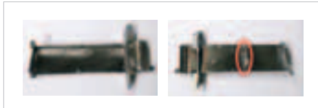
Abbildung 5: Li. unbeschädigte Turbinenschaufel, re. beschädigte Turbinenschaufel (beschädigter Bereich ist rot umrandet)
