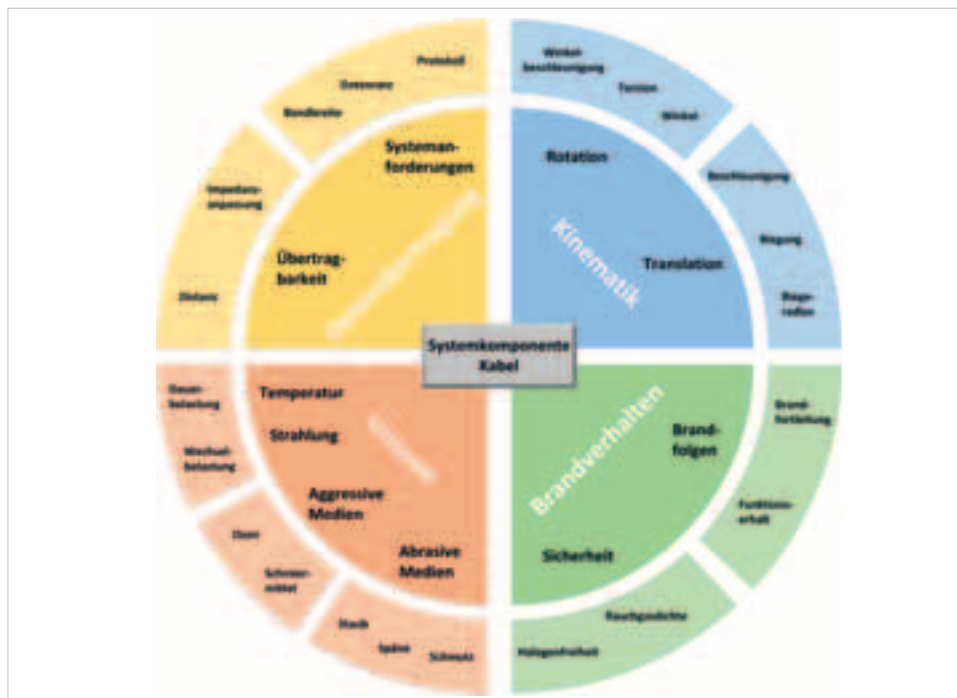
Abb. 2: verdeutlicht die Komplexität der Produktauswahl von Datenkabeln für industrielle Anwendungen anhand wichtiger anwendungsrelevanter Aspekte.
