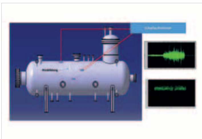
Abb. 1: schematische Wiedergabe eines Druckbehälters mit aufgetragenen Schallsensoren mit Signal- und Auswertedarstellung
