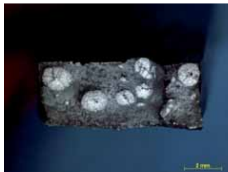
Abb 5: Bruchfläche einer der Flachzugproben
