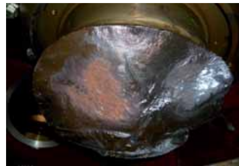
Abb1: Bruchoberfläche der eingebauten Welle
