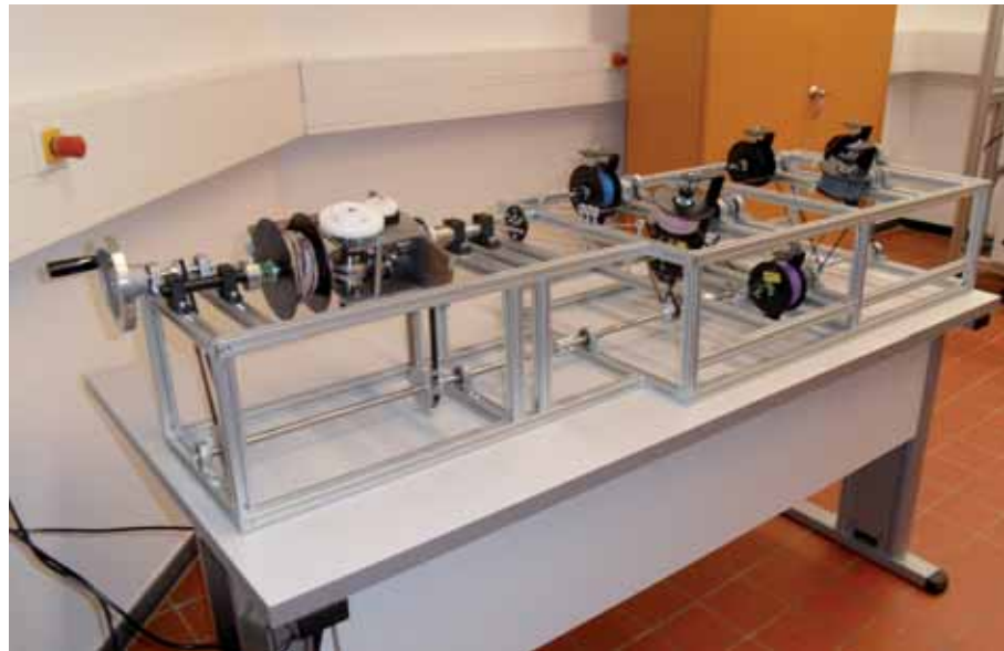
Abb. 2: Erster Prototyp der Verseilanlage
