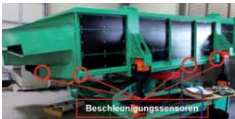
Abb. 6: Siebmaschine mit aufgeklebten Sensoren
