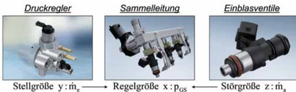
Abb. 1: Modellerte Teilsysteme des Niederdruckbereichs eines Kraftstoffsystems
