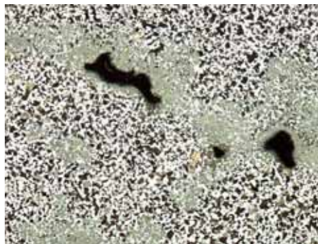
Abb. 6: geätzter Zustand; Vergrößerung 50:1, erkennbar sind Mikrolunker mit Höfen an Seigerungen
