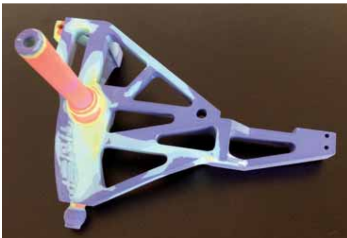
Abb. 2: Prototyp eines Radtragers als Anschauungsmodell mit aufgedruckter Spannungsverteilung eines Lastfalls aus einer FEM-Berechnung (Projekt proTRon)
