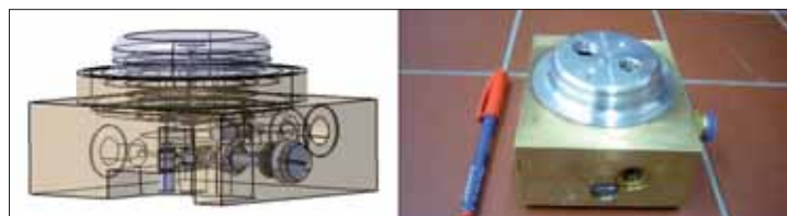
Abb. 3: CAD-Entwurf in CATIA (links) und an der Hochschule Trier gefertigter Prototyp (rechts)
