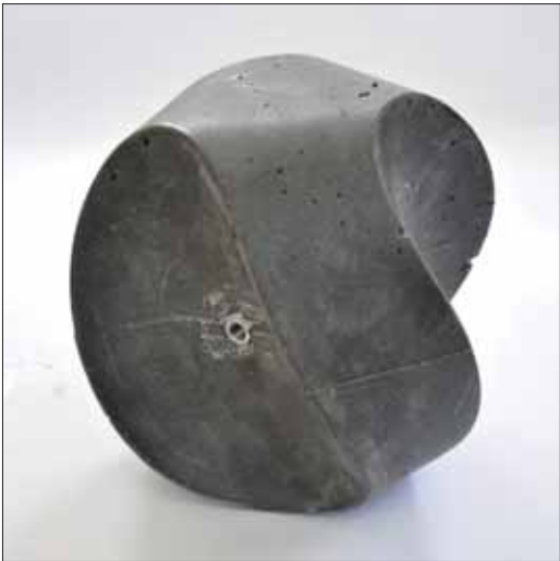
Abb. 6: Innenknoten aus Polymerbeton
