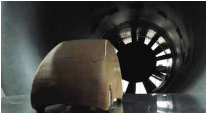
Abb. 4: Ein Modell des proTRon Evolution im Windkanal
