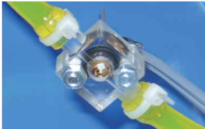
Abb. 1: Kostengünstiger Methanolsensor für Direkt-Methanol-Systeme (FWB,UCB)
