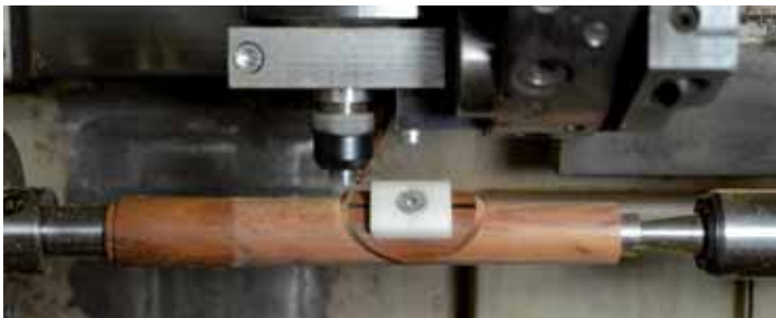
Abb. 5: Dreh- und Fräsbearbeitung des Rohlings eines Kopfstückes in nur einer Aufspannung für eine Querflöte (Kooperationsprojekt mit der Fa. Mancke Flutes)
