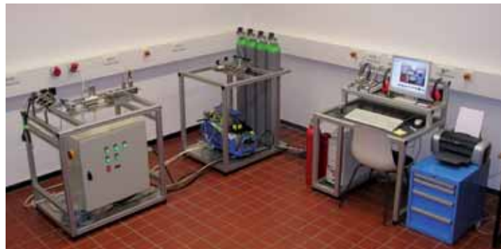
Abb. 2: Prüfstand für Hochdruck-Gastechnik im Fachgebiet Fluidtechnik der Hochschule Trier
