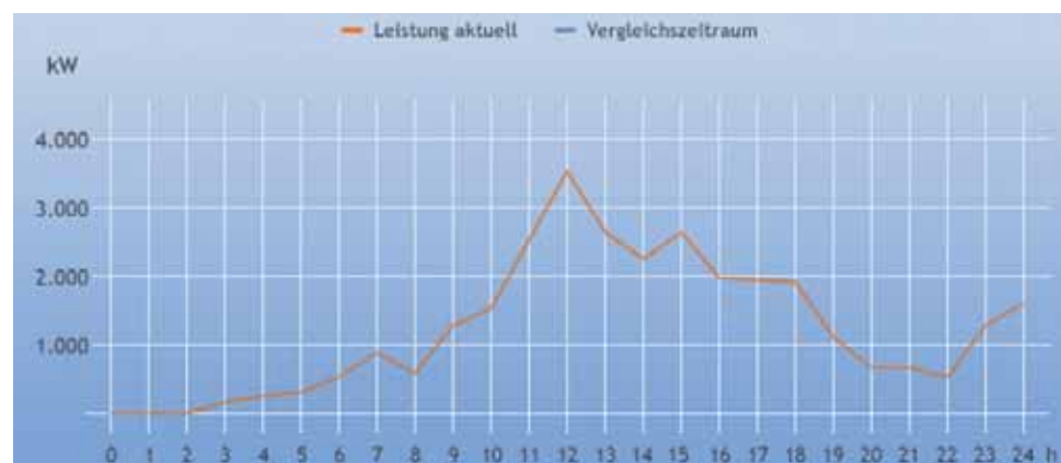
Abb. 1: Tagesverlauf Windkraftwerk Reinsfeld, 14.9.2012. Quelle: Stadtwerke Trier
