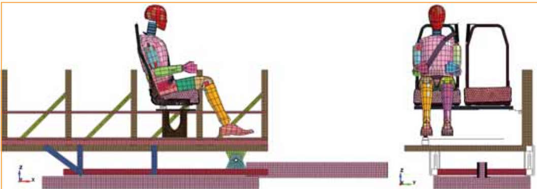
Abbildung 2: Modell eines Schlittentests gem. ECE-R80
