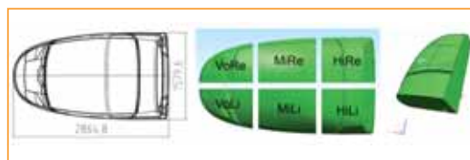
Abbildung 1 Abmessung des Fahrzeugs, in sechs Segmente unterteiltes CAD Modell, das Segment VoLi mit dem Basis-Koordinatensystem
