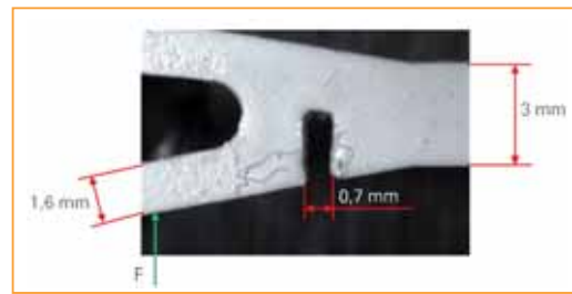
Bild 3: Eine der untersuchten Y-Gabeln mit Angabe der Dimensionen und der Belastungsrichtung
