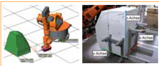
Abbildung 8 Roboter-ausrichtung beim Fräsen von der Seite.
