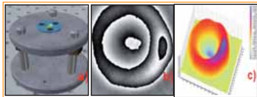
Bild 10: Untersuchte Mikromembrane mit Fertigungsfehler, a) Prüfstand, b) gefiltertes Bild, c) berechnete Verformung
