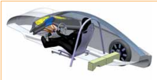
Abbildung 2: Ergonomieuntersuchung des geplanten Instrumententräger in CATIA V6
