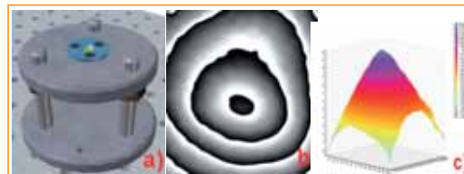
Bild 9: Untersuchte, intakte Mikromembrane, a) Prüfstand, b) gefiltertes Bild, c) 3D-Darstellung der Verformung
