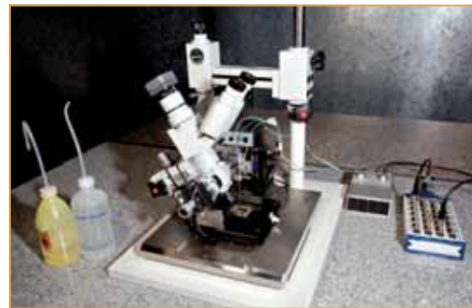
Abbildung 2: Messplatz zur Untersuchung der Feldverteilung von Elektroden am Beispiel eines Mikroelektrodenarrays.
