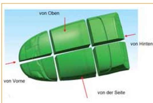
Abbildung 3: Twike-Modell mit Bezeichnung der Bearbeitungsrichtungen
