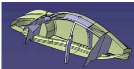
Abbildung 3: Karosseriehalbschnitt mit integriertem Siegerkonzept
