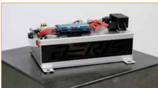
Abbildung 3: „Akkupack“ des proTRon AERIS
