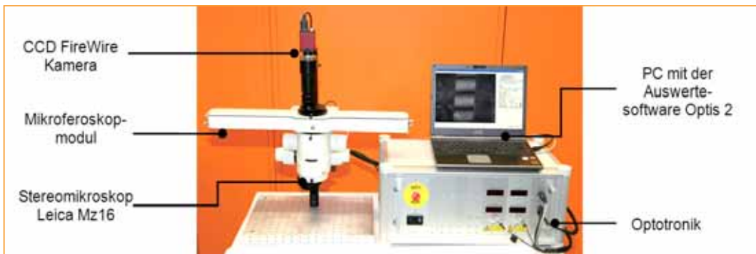
Bild 2: Gesamtaufbau, bestehend aus Mikroferoskopmodul, Kamera, Stereomikroskop, Optotronic und PC mit der Auswertesoftware Optis 2
