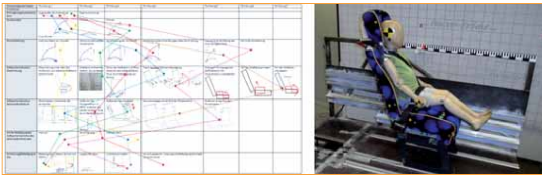
Abbildung 2: Konzeptauswahl im morphologischen Kasten und Sitzprototyp im Crashtest
