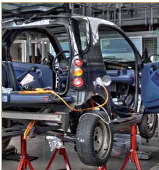
Bild 2: Umbau eines konventionellen Smart zum „E-Smart“
