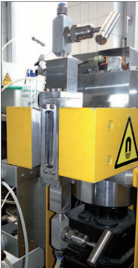
Abb. 6: Patentierte HGMS-Filterkammer im Joch eines Permanentmagneten
