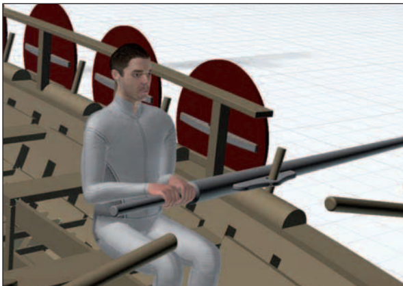
Abb. 15: Ergonomie-Untersuchung mit einem virtuellen Menschmodell
